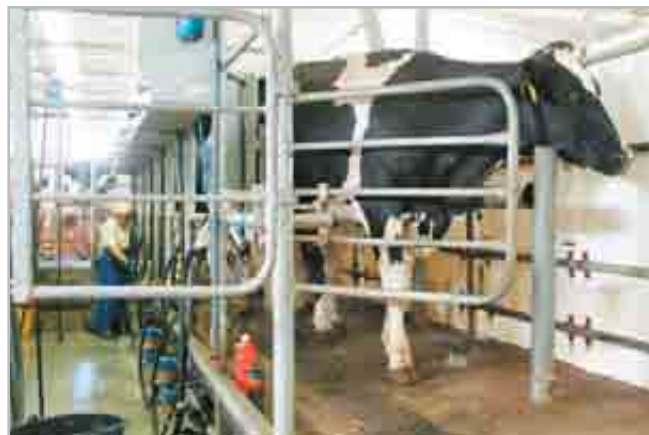
V Úněšově využívaná dojirna Fullwood je osazená většími a výkonnějšími rozdělovači s mléčnými hadicemi o větším průměru
