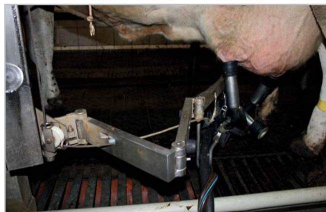
Jednotlivá dojící stání jsou osazena ramenem pomáhajícím při nasazování dojícího stroje Foto Jana Velechovská
